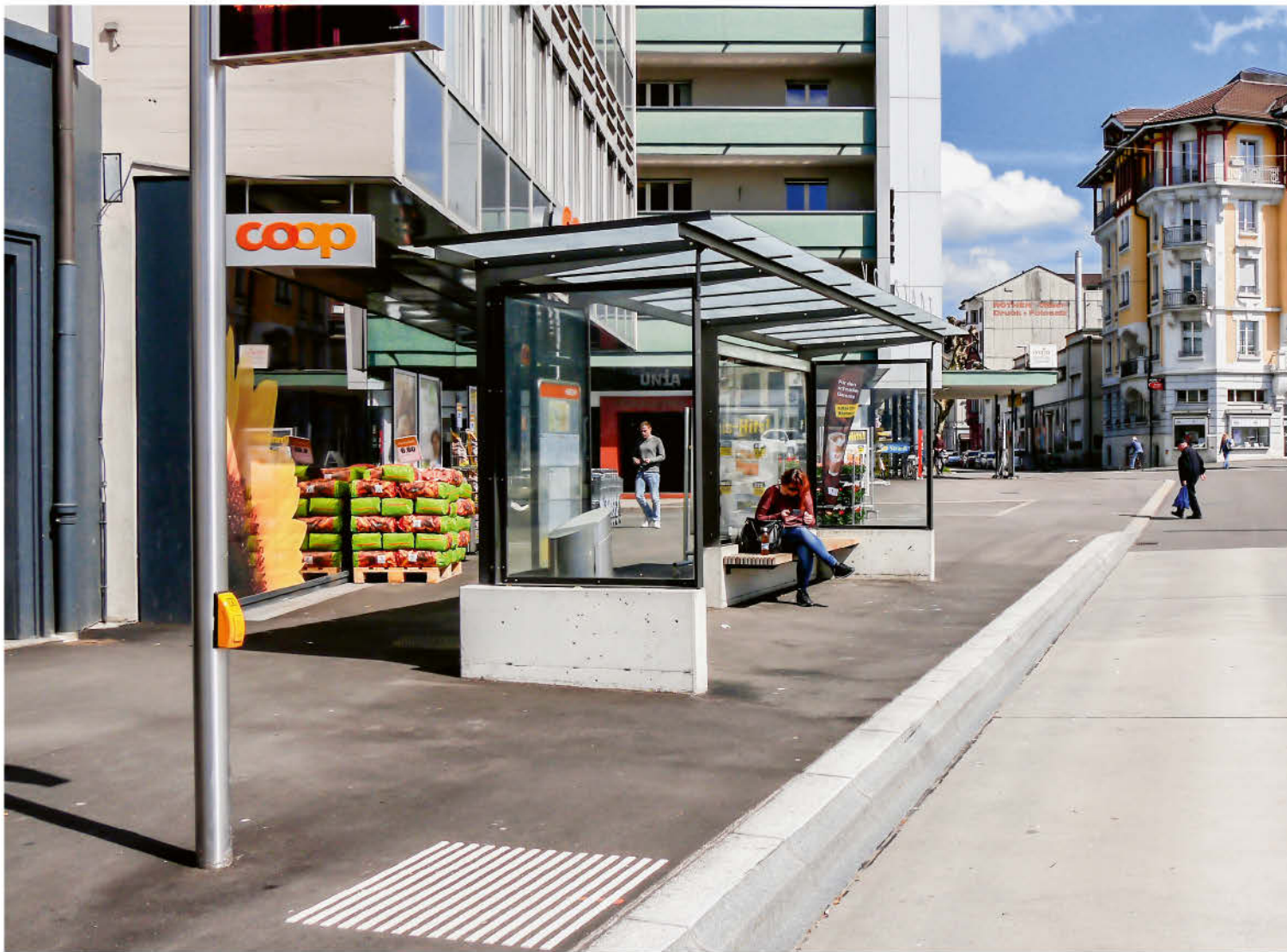
Werden Linien und Abfahrtsinformationen direkt bei der Einstiegsmarkierung angeordnet und auf Anforderung auch akustisch ausgegeben wie hier in Solothurn, sind sie auch für blinde und sehbehinderte Fahrgäste zugänglich.
