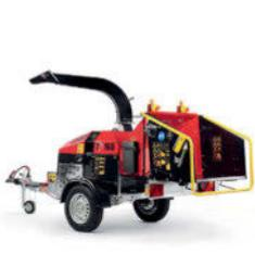
**Déchiqueteuse sur remorque - avec moteur diesel, à essence ou électrique**
