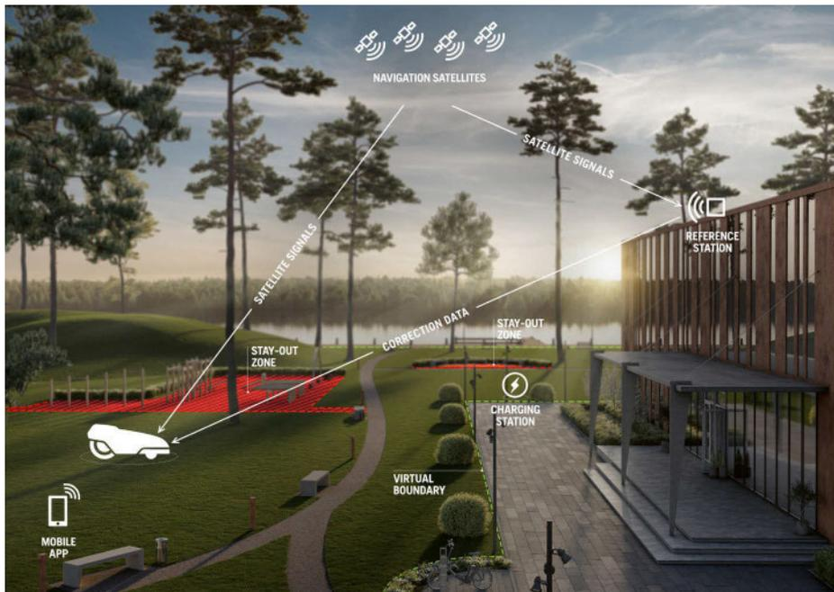
Das EPOS-System von Husqvarna besteht aus Ladestation, Mähroboter, Referenzstation und App fürs Smartphone.
