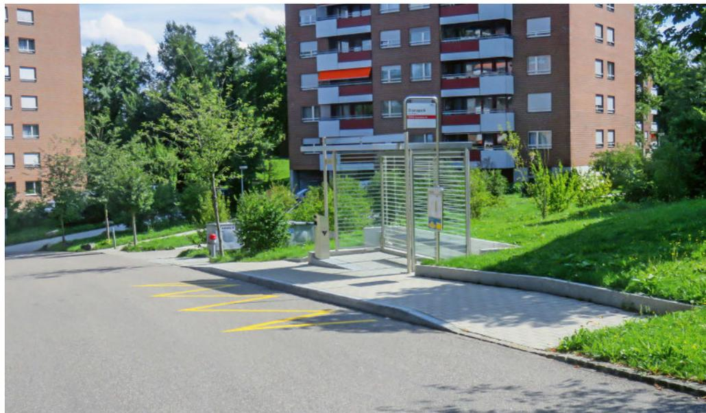
Die Haltestelle Dianapark (Bild rechts) wird heute mit einem Kleinbus angefahren und ist mit einer Haltekannte von 16 cm ausgestattet. Sie wird später vielleicht von einem Normalbus bedient. Sämtliche Wartehäuschen wurden mit vogelfreundlichem Glas gebaut. Bild: zVg.
