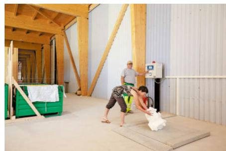
Sagex, Hartplastik, Asche und Mineralöle werden auf einer Bodenwaage gewogen und der resultierende Geldbetrag auf dem Badge belastet.
