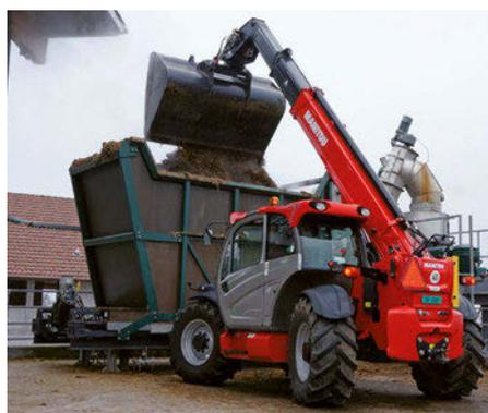
Mit der Leichtgutschaufel schafft der Manitou in 5 bis 6 Fahrten rund 15 m<sup>3</sup> Material in die Biogasanlage
