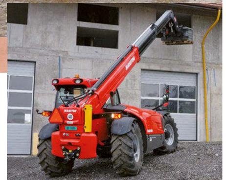
Der Niveausgleich des MLT 1040 ermöglicht, Material unabhängig vom Gelände horizontal vor eine Gebäudeöffnung zu liefern
