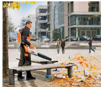
tungspegel ist um 10 dB(A) reduziert. Für Passanten bedeutet dies subjektiv eine Halbierung der Lautstärke. Damit ist das Gerät bestens geeignet für den Einsatz in lärmsensiblen Bereichen wie Parks und Friedhöfen oder
