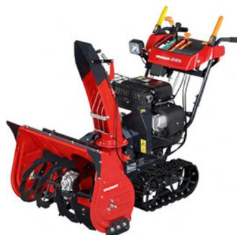
dem leisen Yanmar-Dieselmotoren angetrieben. Mit der Doppelfräse werden Schneehöhen von über 700 mm problemlos beseitigt. Die Räumbreiten gehen von 800 bis 1200 mm. Die Räumleistungen bis 212 t/h und Auswurf-
